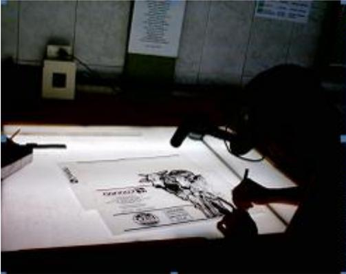
**Montagem:** Para melhor aproveitamento das placas de fotopolímero, montam-se os filmes de acordo com o tamanho de cada placa. A área utilizável das mesmas pode ser de 760 mm x 1200 mm ou 1067 mm x 1524 mm. Os equipamentos possuem uma área de gravação de 1350mm x 780 mm.
